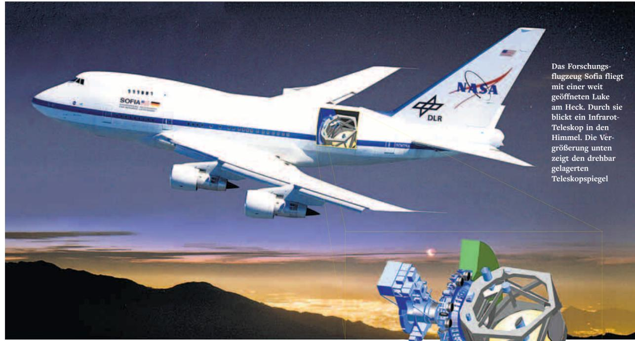
Das Forschungsflugzeug Sofia fliegt mit einer weit geöffneten Luke am Heck. Durch sie blickt ein Infrarot-Teleskop in den Himmel. Die Vergrößerung unten zeigt den drehbar gelagerten Teleskopspiegel
